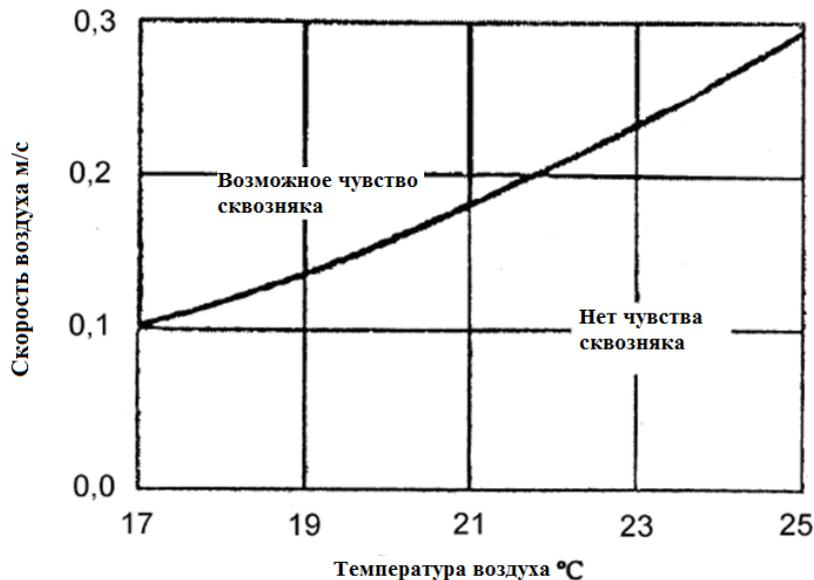
Рисунок 8.2 Ощущение сквозняка в зависимости от температуры внутреннего воздуха и скорости движения воздуха (Kõiv 2006).
