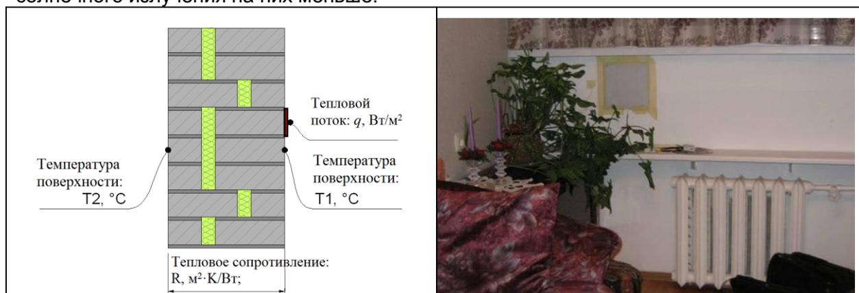
Рисунок 5.2 Схема измерения теплового потока (слева) и измерение теплового сопротивления внешней стены в квартире (справа).
