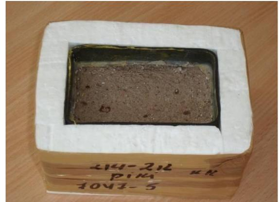
Рисунок 2.9 График зависимости температуры от времени нахождения образца в холодной среде по стандарту (EVS 814:2003) (слева). Образец из силикатного кирпича после 56 циклов замораживания-оттаивания (справа).
